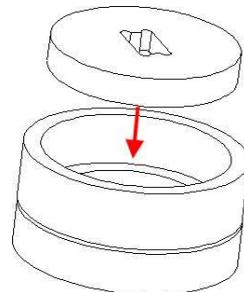
插上制样手柄，握住样品盒，顺时针旋转手柄，直到样品盒盖拧紧，拔下制样手柄。
